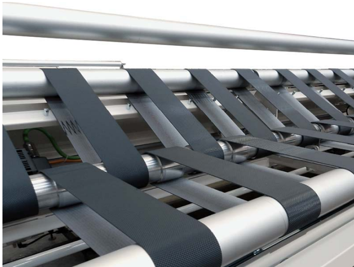
Estructura estándar con cinturones alternos para rollos de \varnothing 50 cm y peso máximo 70 kg
